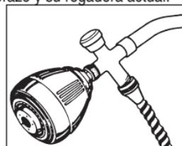
de la perilla o manija, el agua se desvia hacia donde usted desea. El desviador se coloca fácilmente en el brazo con un empaque y cinta para plomero, y la regadera de teléfono al desviador, utilizando también un empaque y cinta para plomero. La manguera se coloca en la salida inferior del desviador. Las regaderas con montaje de pared son las únicas que vienen equipadas con una pieza en donde pueda montar la regadera de teléfono.
