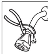
*Nota: Si el brazo de su regadera tiene una esfera en el extremo, no podrá utilizarlo con éste modelo de regadera de teléfono y será necesario cambiarlo.* Le sugerimos el modelo Delta® RP40593.
