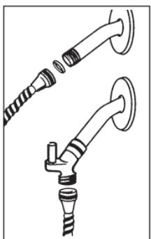
La manguera debe conectarse a una salida de agua: ya sea a la salida del brazo, o a la salida del soporte del brazo. Si tiene un empaque (algunas de nuestras mangueras
