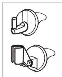
firamente en la pared, asegurándose que el perno quede hacia arriba. **ASEGÚRESE QUE AL PRIMER INTENTO QUEDA CORRECTAMENTE COLOCADO, PUES POSTERIORMENTE NO LO PODRÁ MOVER.** El adhesivo toma 24 horas para obtener su máxima fuerza, permita que pase este lapso de tiempo antes de usarlo
