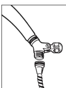
La manguera se debe conectar primero a un adaptador giratorio, que a su vez se conecta a la regadera. El adaptador es la parte que se engancha en
