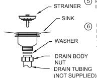
PUSH STRAINER INTO FERRULE IN DRAIN BODY
