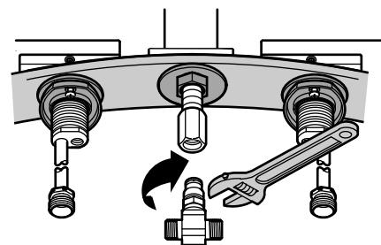
**13** Connect and tighten the hoses. **Do not overtighten!** Connecter et serrer les tuyaux. **Ne pas trop serrer!** Conecte y apriete las mangueras. **¡No apriete demasiado!**
