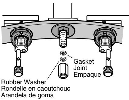
**12** Tighten the tee and align the tee toward the valves. **Do not overtighten!** Serrer et aligner le T en direction des vannes. **Ne pas trop serrer!**
