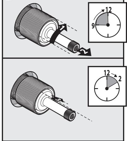
**11** Disengage Splines/Desenganche las ranuras/Dégager les cannelures
