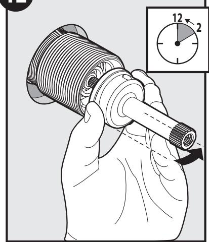
**13** Disengage Splines/Desenganche las ranuras/Dégager les cannelures
