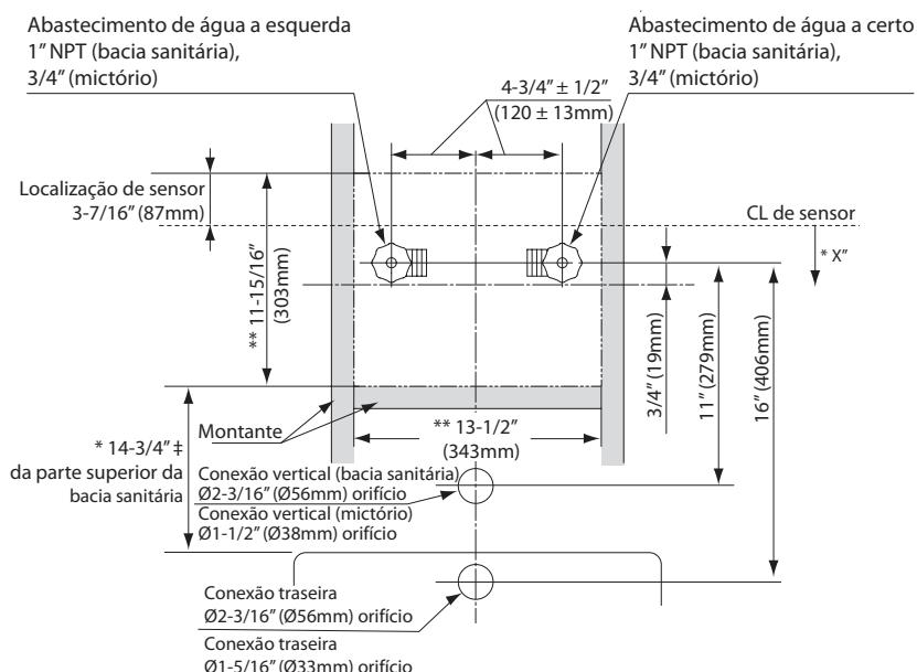
\* X\* = É necessário ao menos um espaço de 12,7 centímetros (5") entre o sensor e a ponta do assento do bacia sanitária levantado ou a ponta da barra de apoio, para evitar falsa detecção.
