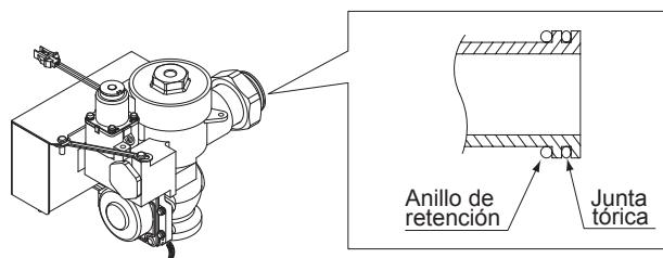
10. Conecte el fluxómetro con la llave de paso y el tubo regulador de vacío.
