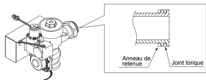
10. Raccordez la valve de chasse avec la soupape de contrôle et le tuyau de reniflard.
