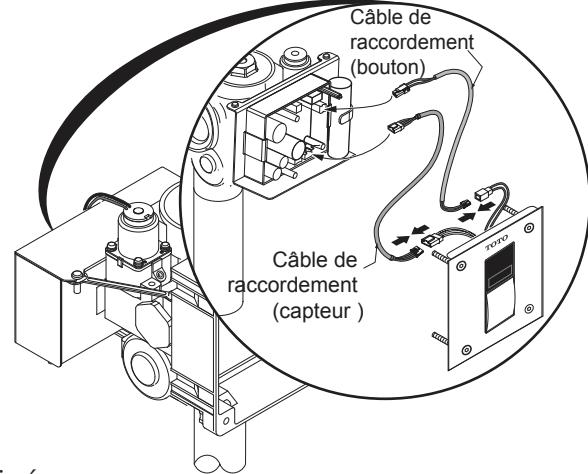
14. Raccordez les câbles du bouton manuel et du contrôleur à l'aide du câble de raccordement.
