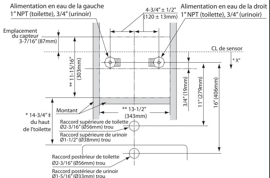
\* X‡ = au moins 127mm (5 po) de dégagement du capteur à la pointe du siège de toilette en position élevée ou du haut de la barre d'appui est nécessaire pour éviter de fausses détections.
