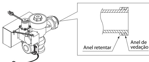
10. Conecte a fluxômetro com o válvula de ponto e o tubo de quebrador de vácuo.
