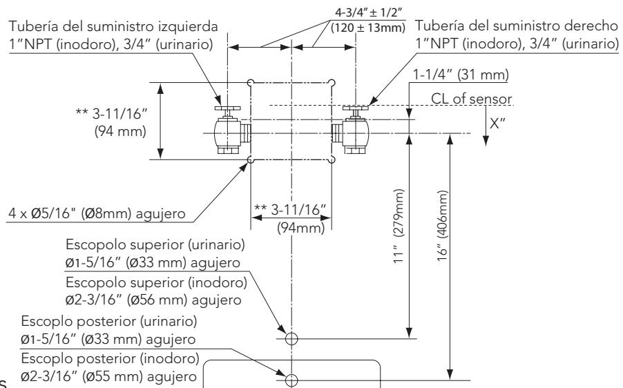
\* X", ‡ = Se requiere al menos 5" de espacio libre desde el sensor hasta la punta del asiento del inodoro o hasta la parte superior de la barra de apoyo para evitar una detección falsa.
