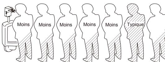
Pour une courte durée d'inactivité, le système suppose qu'il y a une utilisation fréquente de l'urinoir et la valve de chasse décharge moins d'eau.
