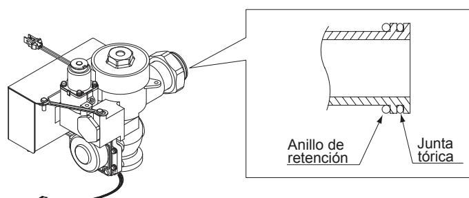
10. Conecte el fluxómetro con la llave de paso y el tubo regulador de vacío.
