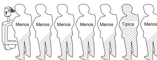
Para los tiempos cortos de inactividad, el sistema asume el uso frecuente del urinario y el fluxómetro suelta menos agua.
