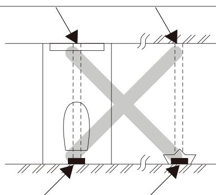
Sensor infravermelho da fluxômetro
