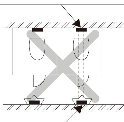
Sensor infravermelho da fluxômetro
