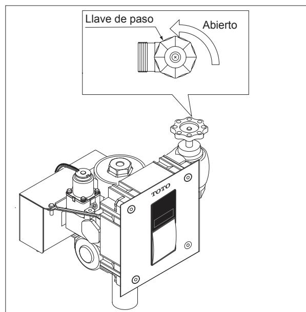
**ADVERTENCIA:** La llave de paso nunca deberá abrirse hasta el punto donde flujo del fluxómetro excede la capacidad de flujo del aparato. En caso de una falla de la válvula, el agua no debe desbordarse del aparato.
