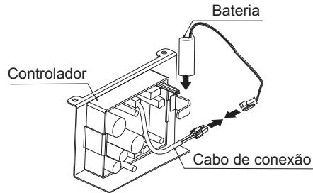
12. Conecte os cabos do sensor infravermelho e do controlador ao cabo de conexão.
