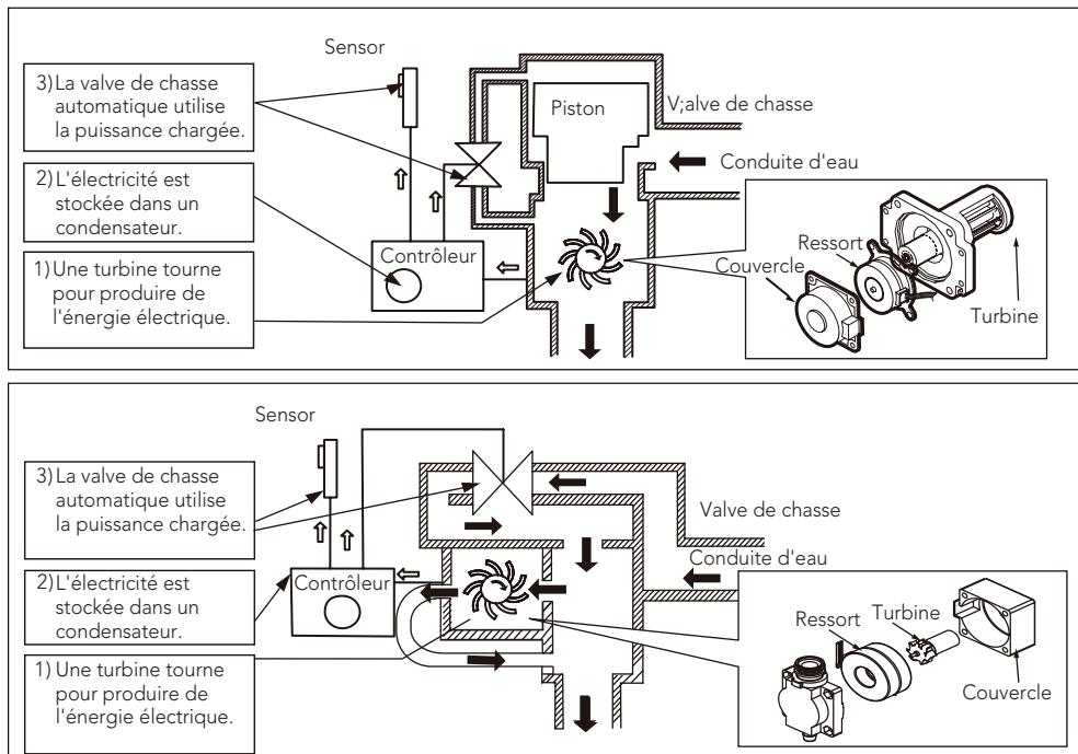
**fig. 1 Générateur Hydropowered**
