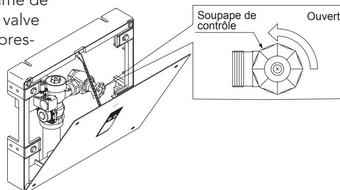
**REMARQUE :** Le soupape de contrôle ne doit jamais être ouvert jusqu'au point où le débit de la valve de chasse dépasse la capacité de débit de l'appareil. Dans le cas d'une panne de la valve, l'eau doit déborder de l'appareil de plomberie.
