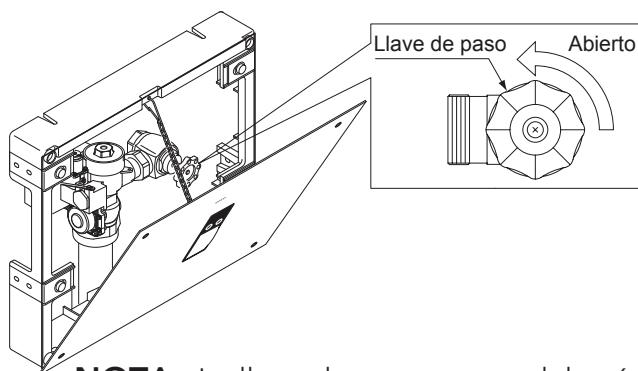
**NOTA:** La llave de paso nunca deberá abrirse hasta el punto donde el flujo del fluxómetro excede la capacidad de flujo del aparato. En caso de una falla de la válvula, el agua debe desbordarse del aparato.
