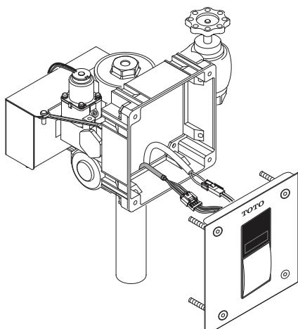
17. Ajuste los tornillos de la cubierta frontal en el bastidor de la base firmemente con la llave hexagonal.
