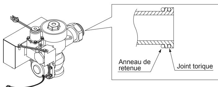
9. Raccordez la valve de chasse avec la soupape de contrôle et le tuyau de reniflard.
