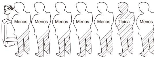
Para tempos ociosos curtos, o sistema supõe uso frequente do mictório e a fluxômetro descarregue um volume menor de água.
