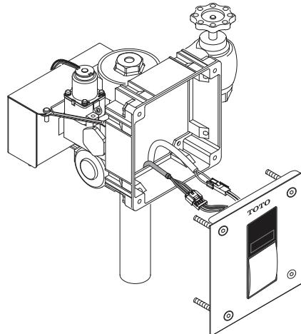
17. Prenda a tampa frontal para o estrutura da base apertando os parafusos com a chave hexagonal fornecida
