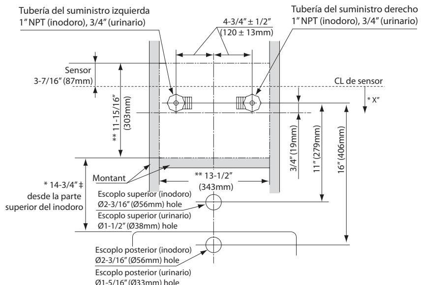
\* X" = Se requiere al menos 5" de espacio libre desde el sensor hasta la punta del asiento del inodoro o hasta la parte superior de la barra de apoyo para evitar una detección falsa. Para la instalación del inodoro.
