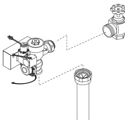
10. Serrez l'écrou de raccordement avec une clé suffisamment pour éviter toute fuite d'eau.
