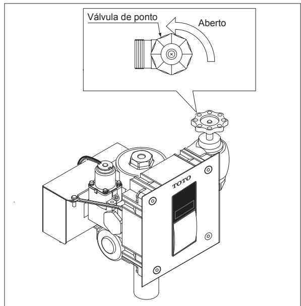
**AVISO:** A válvula de ponto nunca deve ser aberto até o ponto em que o fluxo da fluxômetro a capacidade do fluxo da louça. No caso de falha da válvula, a água no deve transbordar pelo louça.
