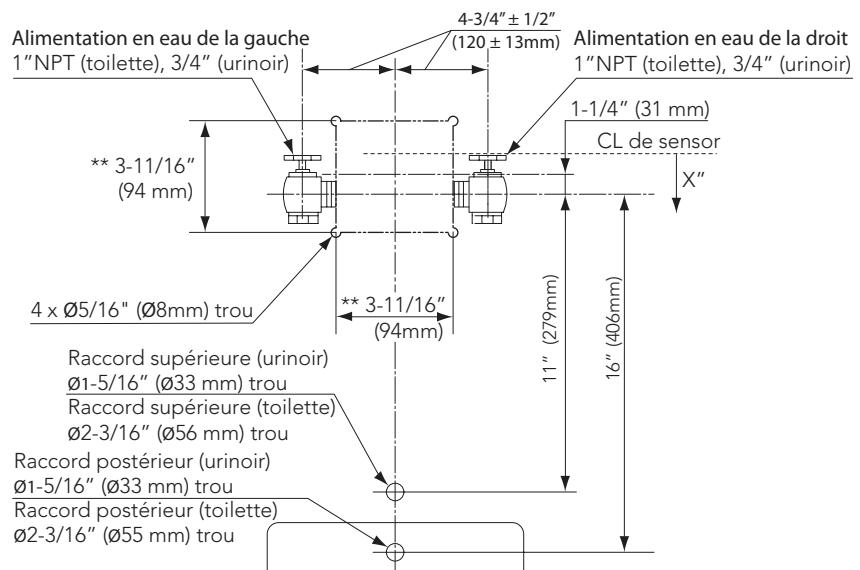
\* X", ‡ = au moins 127mm (5po) de dégagement du capteur à la pointe du siège de toilette en position élevée ou du haut de la barre d'appui est nécessaire pour éviter de fausses détections. Pour l'installation d'une toilette.
