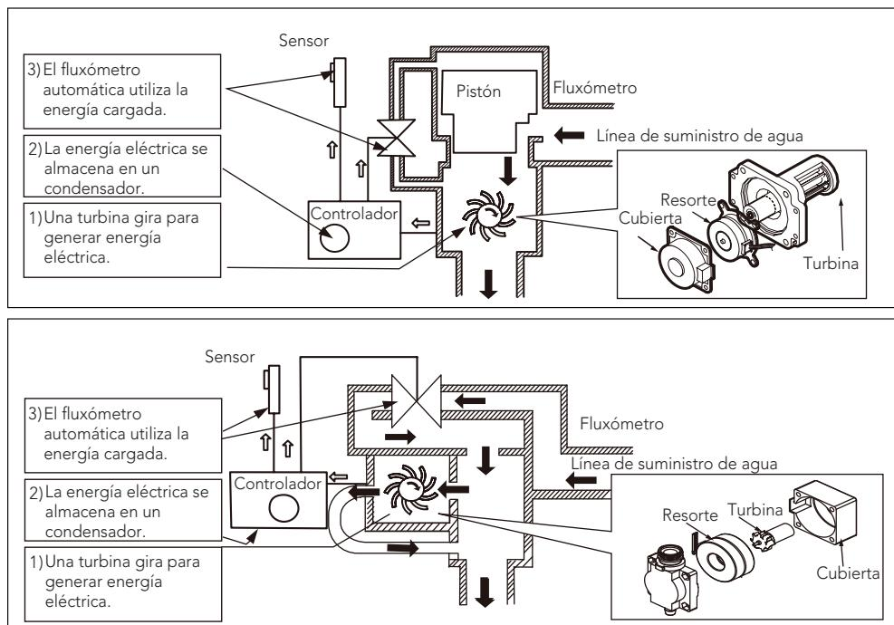
**III. 1 Generador de Energía Hidráulica**
