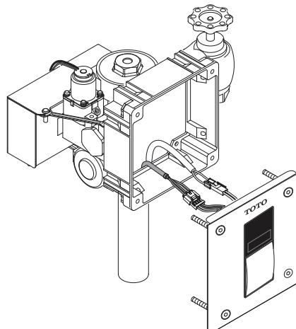
16. Serrez fermement les vis avant du couvercle dans la base du cadre avec la clé hexagonale.
